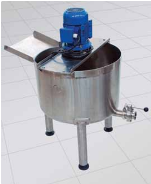
Equipo de homogeneización suave diseñado por el proyecto, fabricado en acero inoxidable con capacidad de 100 a 200 litros cada diez minutos, sistema fijo y motor.
