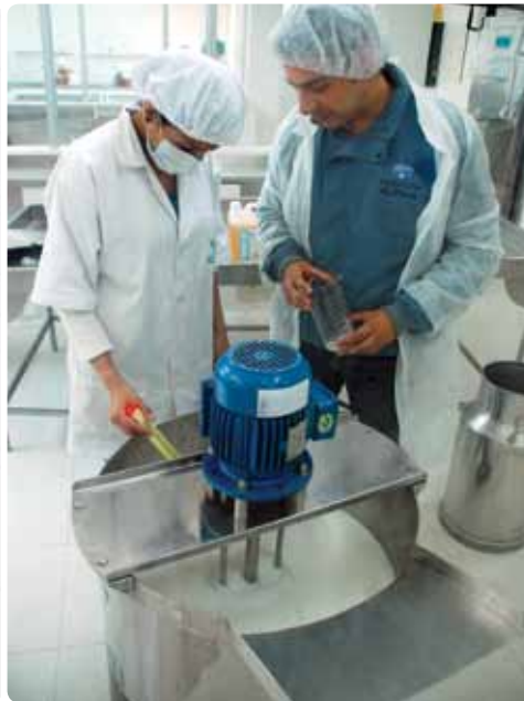
Equipo de homogeneización suave diseñado por el proyecto, fabricado en acero inoxidable con capacidad de 100 a 200 litros cada diez minutos, sistema fijo y motor.
